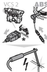
4 - Manualmente coloque o sensor ABS na posição correta (não use martelo)
