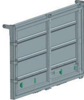
A tampa traseira uma abertura tem o seu funcionamento semi-automático, isso é, a carga e a inclinação da caixa fazem com que a tampa abra e a carga escoe.
