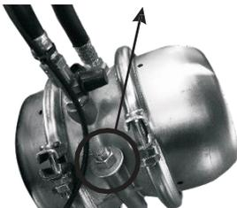
(1) Libere a porca e retire o parafuso (Figura 36) do suporte da câmara de emergência (Spring Brake).
