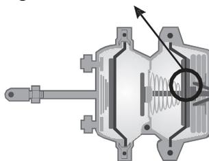
(2) Prenda o parafuso ao emboło de acionamento através da abertura localizada acima da câmara de emergência.
