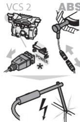
4 - Manualmente coloque o sensor ABS na posição correta (não use martelo)
