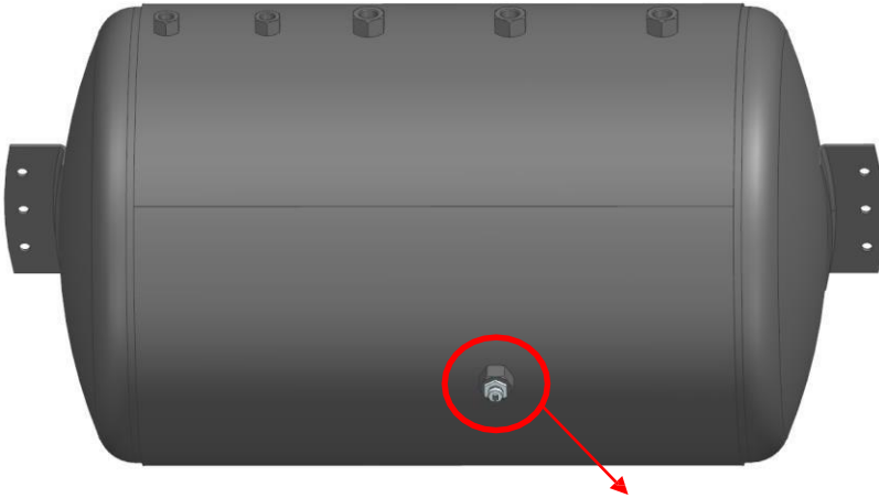
VÁLVULA PARA DRENAGEM FIGURA 47
