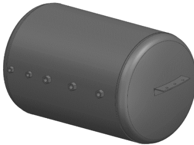
RESERVATÓRIO DE AR
