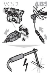
4 - Manualmente, coloque el sensor ABS en la posición correcta (no use un martillo)
