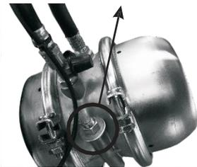
(1) Suelte la tuerca y retire el tornillo (Figura 36) del soporte de la cámara de emergencia (Spring Brake).
