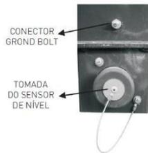
5. Se carga o descarga el tanque. Durante la carga, el sensor de nivel óptico informa a la base cuando el compartimento se llena. En el caso de que alguno de los componentes esté con defecto, la base de abastecimiento no permitirá que se cargue combustible en el tanque.
